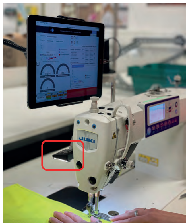
Figure 1: Nähmaschine mit Retrofit-Kit (Kamera an Maschinenrückseite sichtbar) in aktueller Ausbaustufe
