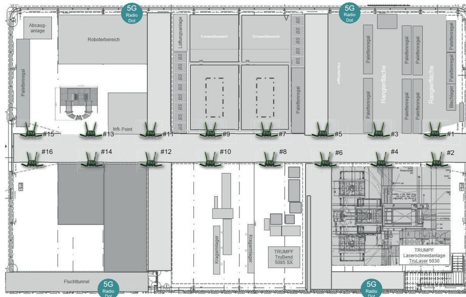
Bild 7: Hallenplan und Positionierung der STING-Devices (eigene Darstellung)
