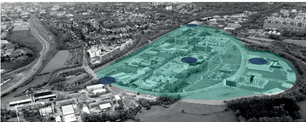
Bild 6: Panorama des 5G Industry Campus Europe auf dem Campus Melaten der RWTH Aachen mit Visualisierung der 5G-Abdeckung und Antennenplatzierung
