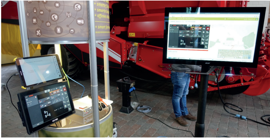
Bild 25: Smart-Farming-Installation am Teststand – links oben: Smart Terminal, darunter Maschinen-ISObus-Terminal, Mitte: Kommunikationsmodul, rechts: Plattform mit Teleservice-„App“
