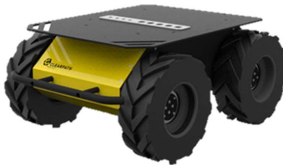
Abbildung 3: Husky-AGV, das ROS implementiert und folglich freikonfigurierbar ist
