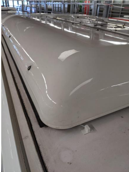
Abbildung 28: Detailansicht des Lufteinlasses entgegengesetzt zur Fahrtrichtung
