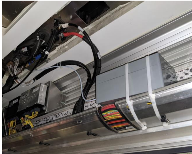
Abbildung 26: Befestigung des Sensors im Elektronik-Regal des Busses sowie Verlegung der Kabel zur Sicherungsbox sowie zum Dach (Lufteinlass)
