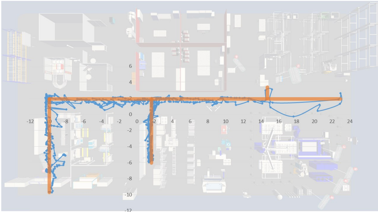
Abbildung 23: Zusatztest mit SICK UWB-System, starke Abweichungen in der Positionserfassung
