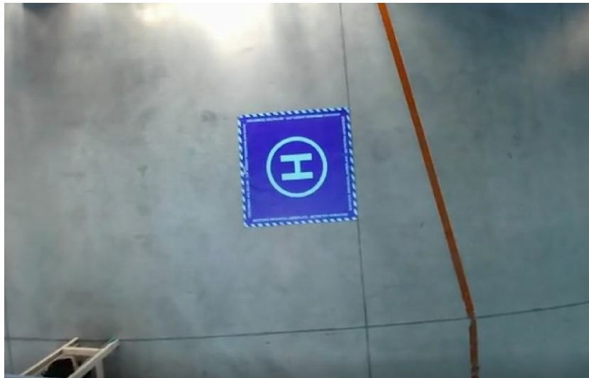
Abbildung 27 - Live-Aufnahme der Unterboden-Kamera zur Positions- und Objekterkennung in ca. 5 m Höhe (RTSP-Stream)
