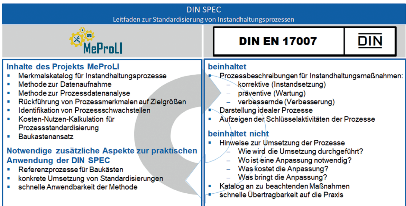
Bild 1: Entwicklung einer DIN SPEC aus dem Projekt MeProLI in Ergänzung mit der DIN EN 17007 (eigene Darstellung)
